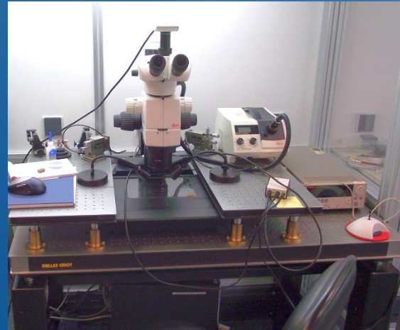
Loupe binoculaire + micromanipulateurs + pointes de mesures DC
